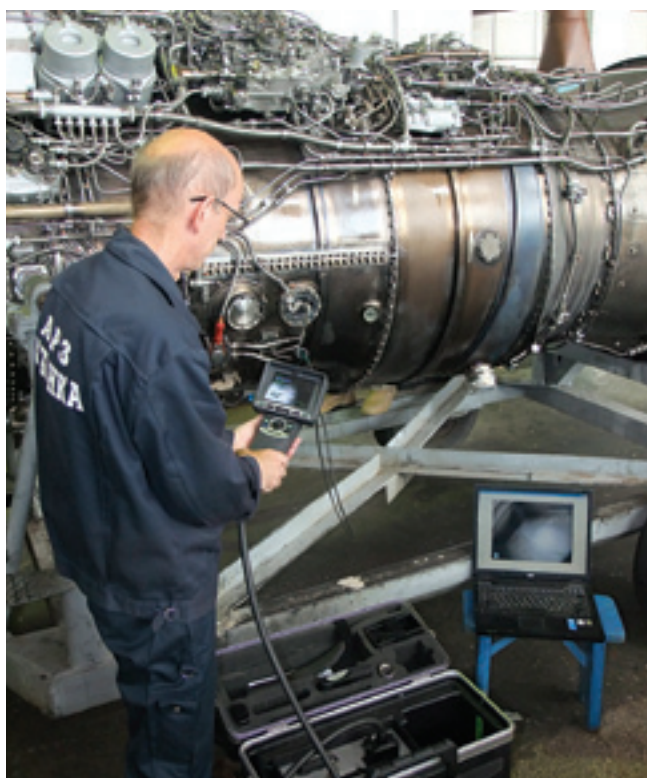
Осмотр газоздушного тракта двигателя
