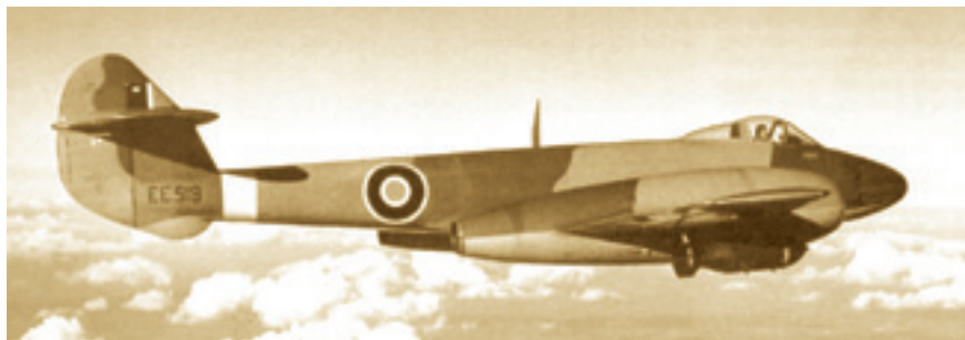
Meteor F Mk.4 (бортовой номер EE519) сохранивший камуфляж военных лет, выполняет тренировочный полет на бомбометание. Под крылом подвешены две бомбы калибра 227 кг (500 фунтов)
