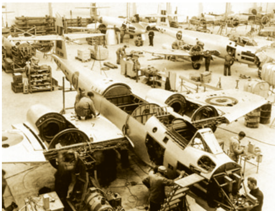
Сборка самолетов Meteor F Mk.8 в Бельгии из комплектующих поставляемых заводами Fokker (Голландия) и Gloster (Англия)
