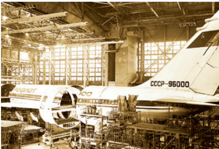
Стыковка фюзеляжа самолета Ил-96МО
