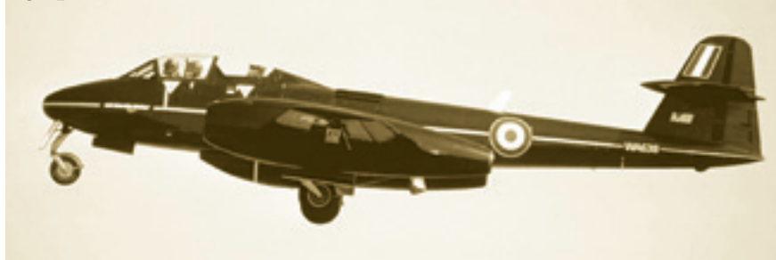
Летающая лаборатория Meteor T.7S (бортовой номер WA638) на котором проводились испытания катапультных кресел фирмы Martin-Baker
