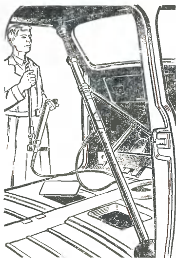
Рис. 53. Правка прогиба в крыше (в дверном проеме) кузова
