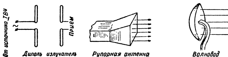
Рис. 2. Бесконтактная передача энергии электромагнитным излучением (различные варианты антенн).
