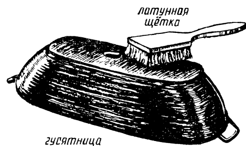
Рис. 18. Подготовка чугуна к пайке
