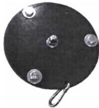
**НИВЕЛИРНЫЙ БАШМАК** ПРЕДНАЗНАЧЕН ДЛЯ УСТАНОВКИ НА НЕГО РЕЙКИ ПРИ НИВЕЛИРОВАНИИ КРУТЫХ ПОДЪЕМОМОВ И СПУСКОВ ПО МЕТОДУ «ИКСОВЫХ» ТОЧЕК ИЛИ ПРИ ПРИВЯЗКАХ К ГОСУДАРСТВЕННЫМ МАРКАМ И РЕПЕРАМ БЕЗ ЗАБИВКИ КОЛЬЕВ.
