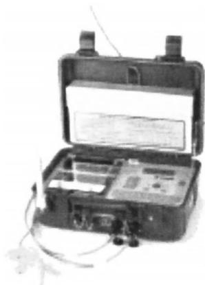
Рис. 4. Сейсмограф BlastMate Series III. Общий вид.
