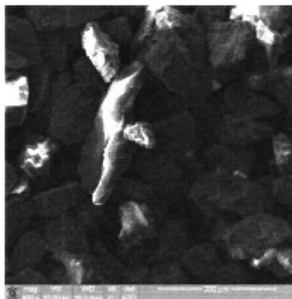
Рис. 4. Магнетитовый концентрат до (а) и после отмывки (б) (класс +0,045 мм, зерна магнетита (темное), увел. 5000).
