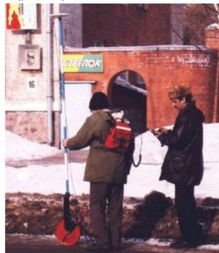
Рис. 3. Крепление на полевой курвиметр для съемок асфальтобетонного покрытия
