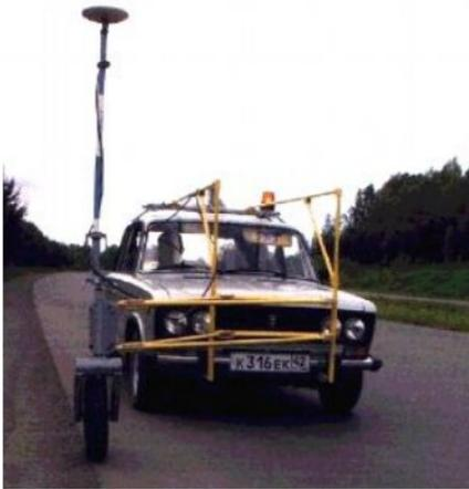
Рис. 5. II тип крепления антенны
