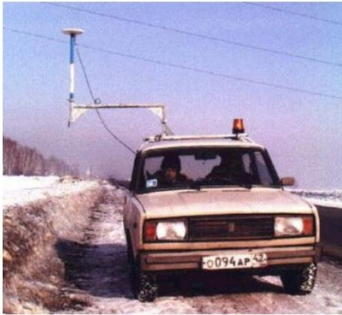
Рис. 4. I тип крепления антенны
