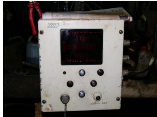
1. блока управления, в котором хранится вся информация. В этом блоке имеется возможность менять проектные данные и вносить поправки.
