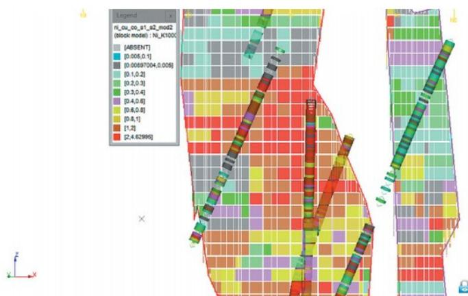
Рис. 2. Пример визуального сравнения содержаний никеля в пробах разведочных скважин и оценок с помощью кригинга в блоках модели с размерами 5 × 5 метров в минерализованной зоне S1\_S2
