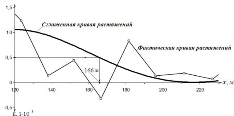
Рис. 6. Определение границы мульды по сглаженной кривой относительной горизонтальной деформации
