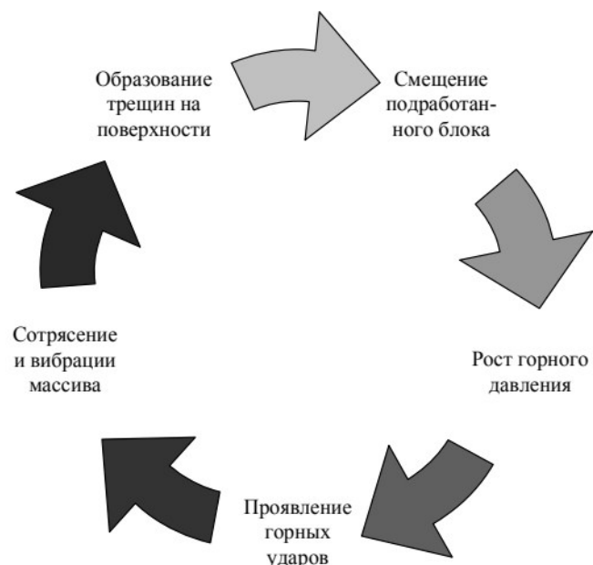
Рис.5. Схема взаимосвязи процесса деформации земной поверхности и техногенной сейсмичности
