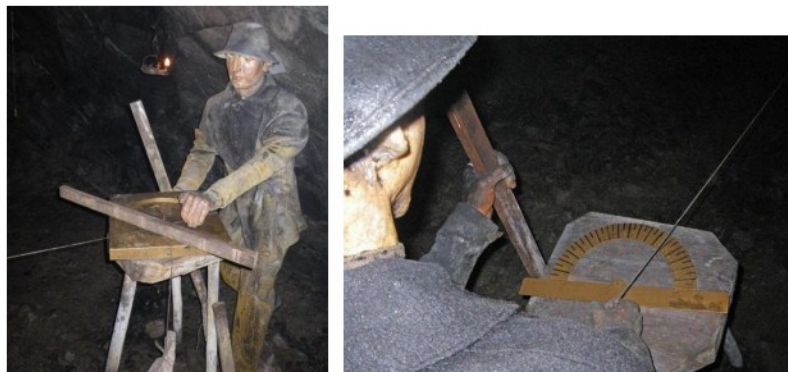
Рис.2. Маркшейдер с мерным шнуром и угломером. Реконструкция. Горный музей в Шнееберге. Фото А.М.Винтер, 2009
