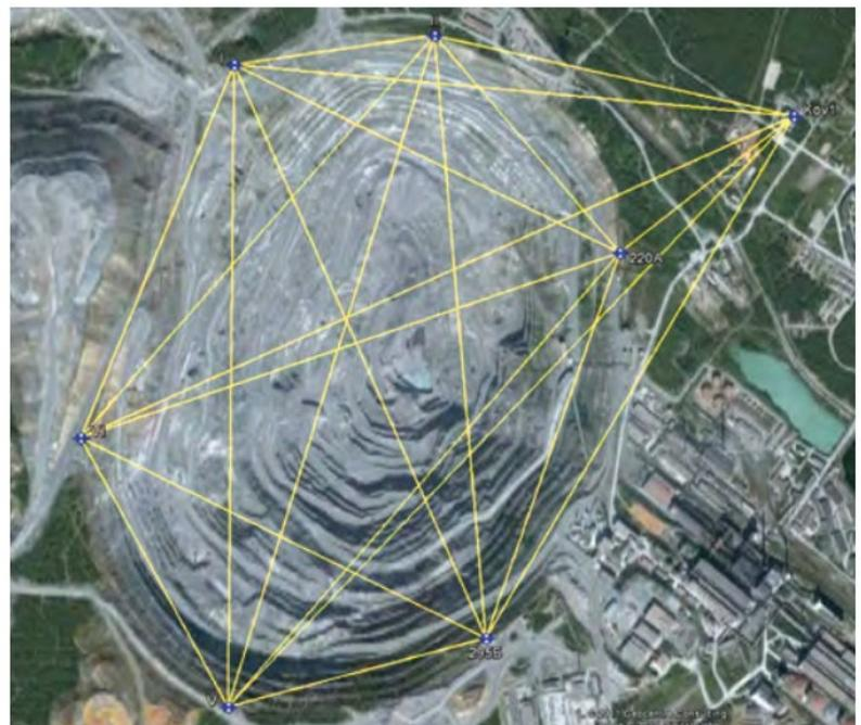
**Рис.7. Геодезический полигон на карьере «Железный» и схема наблюдений [9]**
