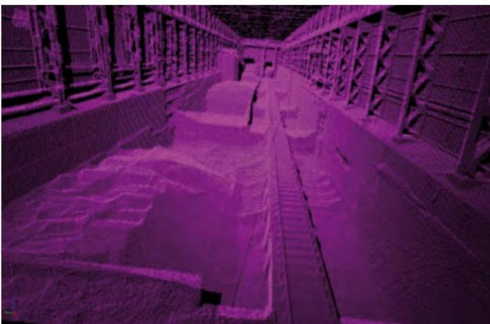
Рис. 3. Пример облака точек при выполнении съёмки крытых складов наземным лазерным сканером
