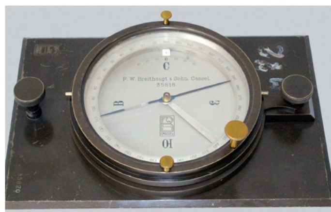
Рис. 5. Переносец – «лежащий» компас. Германия, Кассель, F. W. Breithaupt & Sohn, конец XIX – начало XX века. Музей маркшейдерского дела (ММД-227)
