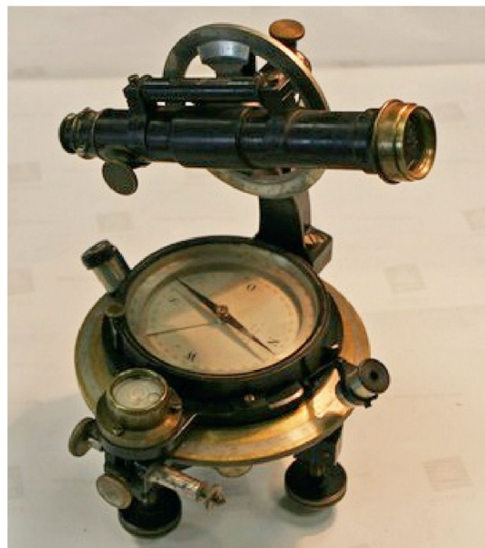
Рис. 18. Теодолит горный с буссолью на опоре (румбы против часовой стрелки). Российская империя, Царство Польское, Варшава, Г. Герлях (G. Gerlach), 1900–1904. Музей ГСИ (№ 374)
