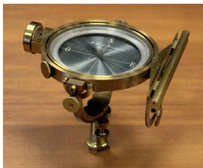
Рис. 16. Буссоль маркшейдерская штативная на карданном подвесе с угломером. Бельгия, Брюссель, А. Tisch-Meulemans, начало XX века. Музей ООО «Геостройизыскания» (ГСИ-520)
