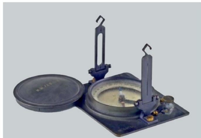
Рис. 14. Буссоль с диоптрами. Германия, Фрайберг, Hildebrand. I половина XX века. Музей ООО «Геостройизыскания» (ГСИ-394)
