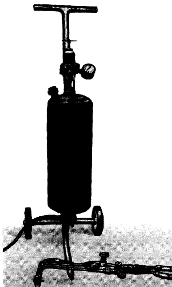
Рис. 2.13. Установка для кислородно-флюсовой резки
