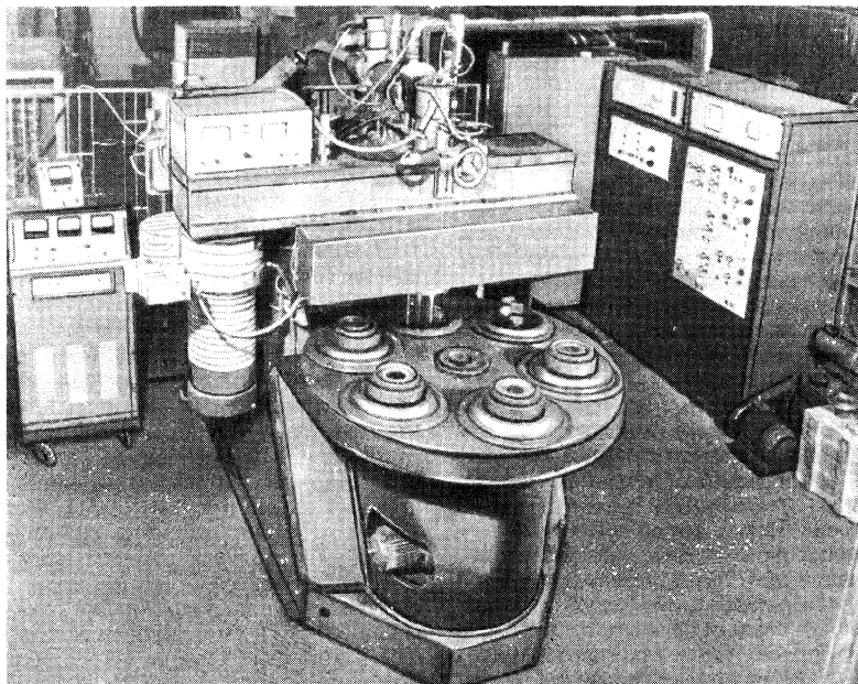
Рис. 1.30. Установка УЛ157 для ЭЛС изделий массового производства
