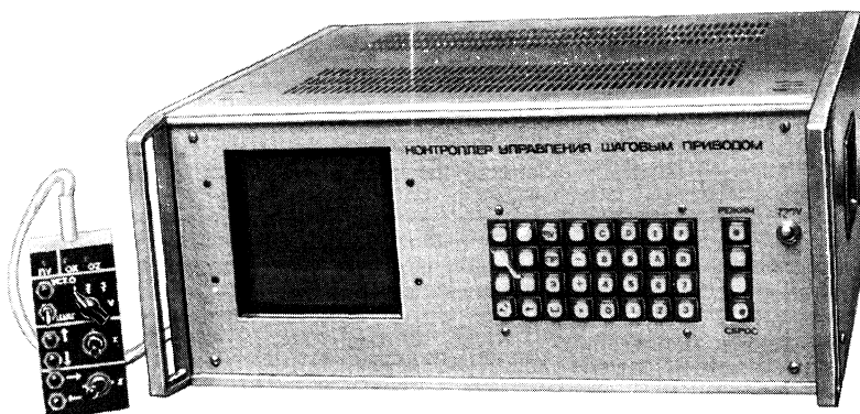
Рис. 1.33. Блок программного управления "Путь-1"
