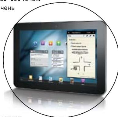
В обоих планшетах установлены двухъядерные процессоры nVidia Tegra 2 с тактовой частотой 1 ГГц, а также 1-Гбайт оперативная память. Работают устройства достаточно быстро.
