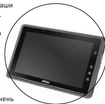
Экран 110W имеет разрешение 1280×800 точек. Матрица IPS, как и у iPad, — яркая и качественная. Сенсорный отклик отличный, поддерживается Multitouch. Для тех, кому управление с экрана не по душе, предусмотрен оптический джойстик, расположенный справа от дисплея. Его местонахождение удобно — он ложится как раз под большой палец. Под ним размещаются сенсорные клавиши Windows, «Домой», «Выход из системы».
