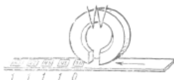
Рис. 13. Представление информации на поверхности магнитного диска
