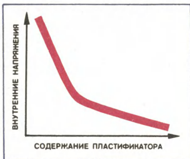
Рис. 4. Влияние содержания пластификатора на внутренние напряжения, возникающие в пленке нитроцеллюлозного лака.
