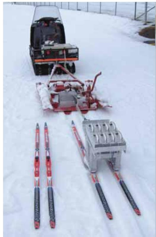
Специальная установка для измерений сопротивления лыж при скольжении под различной нагрузкой выполнена на базе снегохода. Измерения проводятся на ровном участке профилированной лыжни, что повышает воспроизводимость и точность измерений
