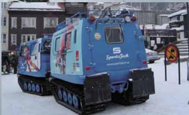
Гусеничные вездеходы BAE Hägglund BV 206, производимые шведской компанией «Бае Хагглунд», подарены университету шведскими вооруженными силами. На их основе созданы три мобильных измерительных лаборатории. Однако даже такие гусеничные машины большой проходимости не могут работать очень высоко в горах. Тогда исследователям приходится превращаться в шерпов и нести оборудование на своих плечах
