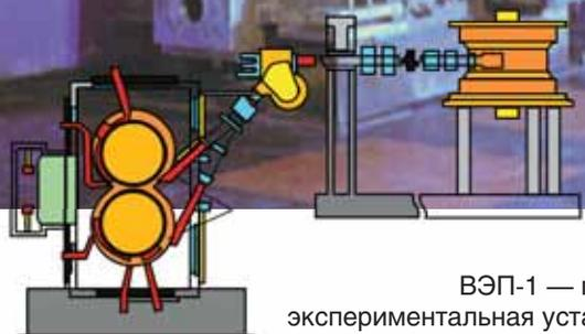
ВЭП-1 — первая экспериментальная установка ИЯФ СО РАН со встречными электронными пучками с энергией  $2 \times 160$  МэВ
