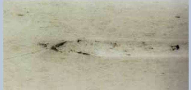
Скользящая поверхность лыж, обработанная парафином («мазью скольжения»), собирает с поверхности лыжни различный мусор. Приклеившись к лыжам, он ухудшает качество поверхности и приводит к постепенному увеличению торможения
