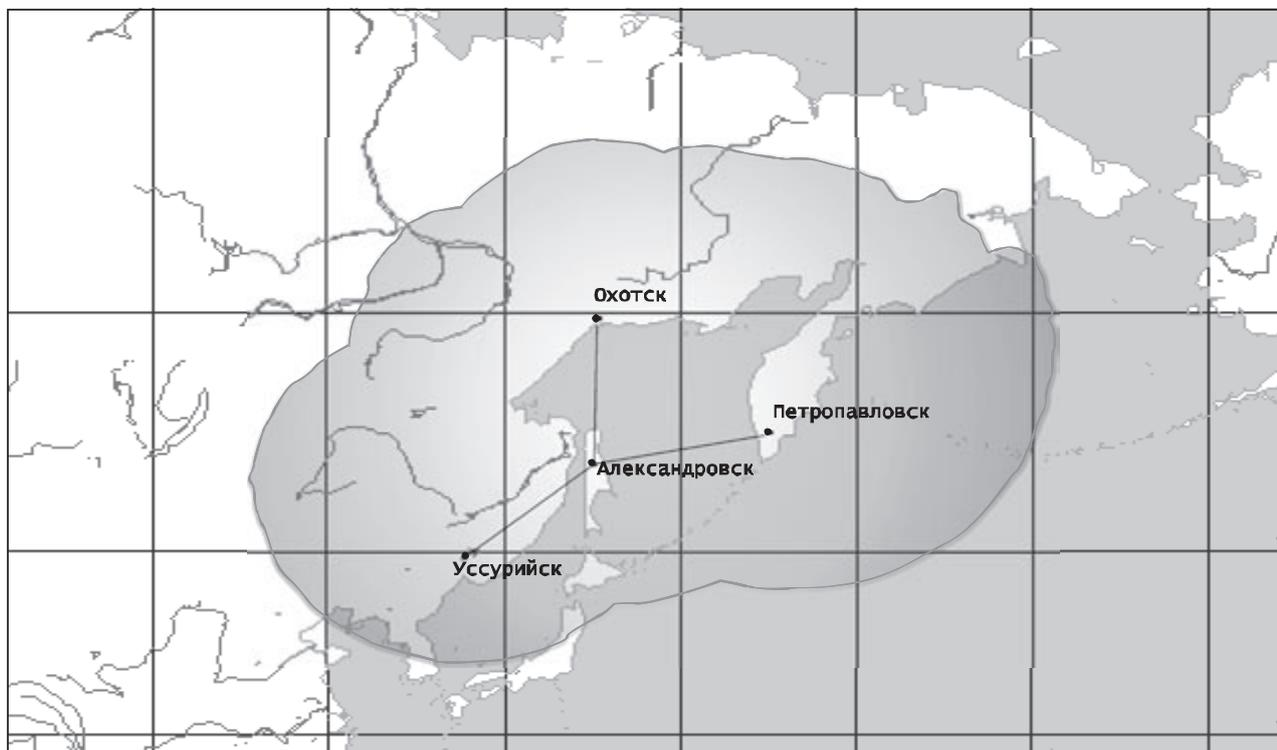
**Рис. 1.** Расчетная рабочая зона региональной дифференциальной подсистемы ГНСС на базе четырех станций Дальневосточной цепи системы «Чайка» (без учета влияния перекрестных помех)
