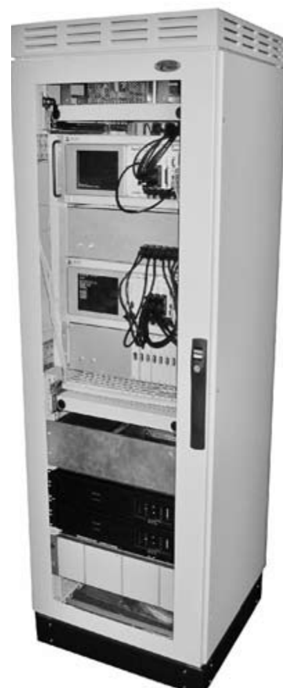
Рис. 3. Локальная контрольно-корректирующая станция ЛККС-А-2000
