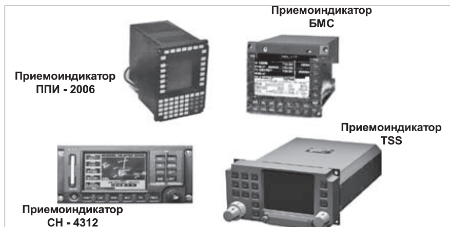
Рис. 2. Перспективные отечественные приемоиндикаторы ГЛОНАСС/GPS
