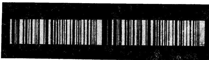
Рис. VII.58. Спектральная диафрагма, содержащая 126 щелей
