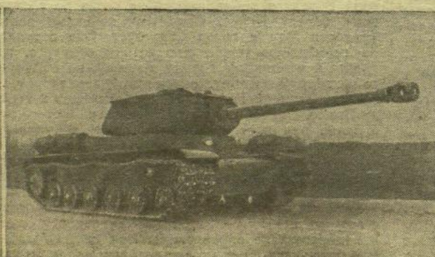
122-мм пушка, установленная в тяжёлом танке.
