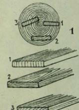
Прежде всего, надо выбрать сухие, прочные доски 12 см ширины, 3 см толщины. По изгибам древесины надо выбрать такие, которые вырезаются в стволе не поперек и не вкось сучья, а как показано на рис. 1(2), т.е. чтобы линии древесины проходили по широкой плоскости доски. Конечно, лучше по возможности вовсе избегать сучья.
