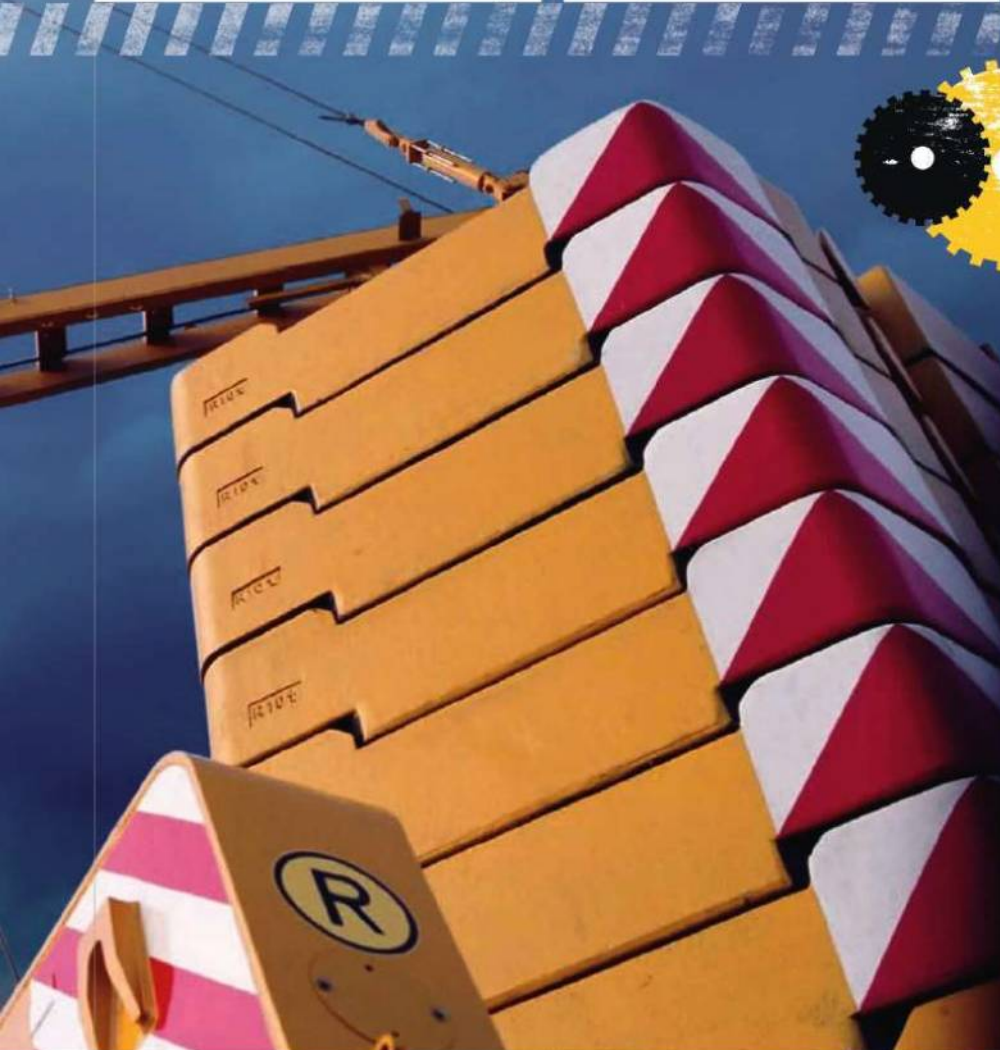
ДЕРРИК-КРАН Одна из конструкций, обеспечивающих высокую грузоподъемность, называется деррик-краном. Ее характерная особенность – наличие второй, вспомогательной стрелы, которая работает как оттяжка. В деррик-кране используется дополнительный “плавающий” (подвесной) балласт.
