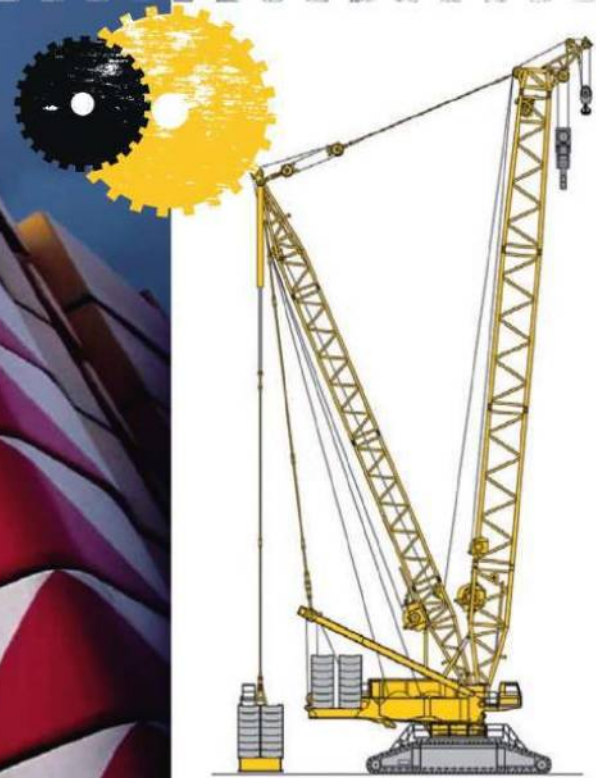
ДЕРРИК-КРАН Одна из конструкций, обеспечивающих высокую грузоподъемность, называется деррик-краном. Ее характерная особенность – наличие второй, вспомогательной стрелы, которая работает как оттяжка. В деррик-кране используется дополнительный “плавающий” (подвесной) балласт.
