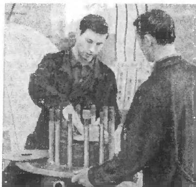
Рис. 3. Сборка внутренней обмотки магнита. С магнита снят наружный кожух. Видна часть обмотки и стяжные болты. Обычно переборка магнита с целью очистки его витков от коррозии и механических загрязнений производится через 150—250 часов работы.
