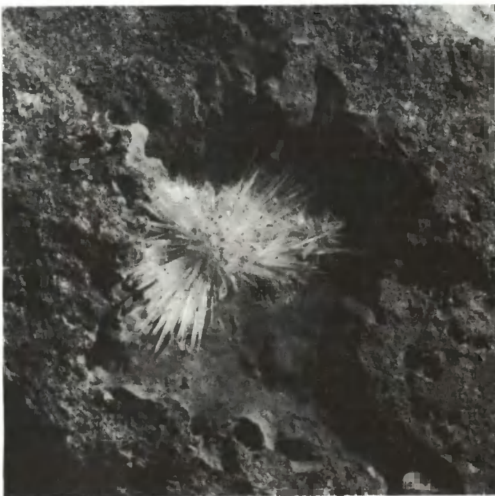
«Щетка» кристалликов арагонита ( \text{CaCO}_3 ), выросшая в одной из газовых полостей, которые пронизывают базальты скважины 454. [Увел. в 20 раз].
