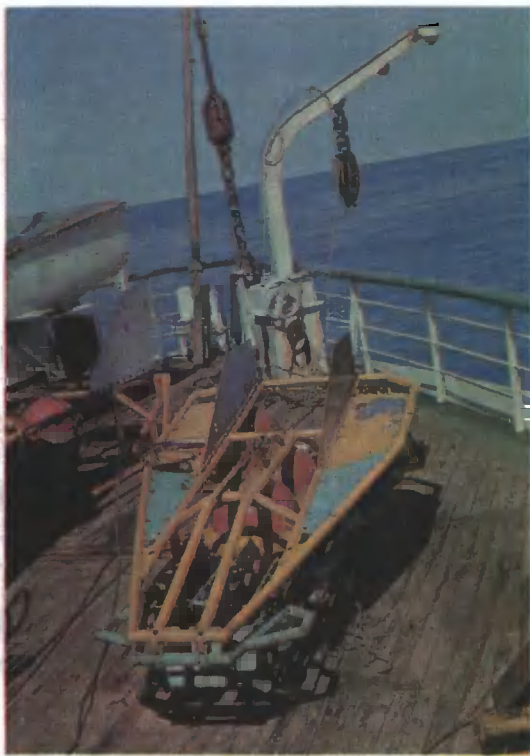
Буксируемый подводный аппарат типа «Зук». Фото В. С. Ястребова.
