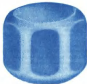
Равновесная форма кристаллов гелия при низких температурах ( < 0,9 К). При температурах 0,9 \text{ К} < T < 1,2 \text{ К} остаются только верхний и нижний плоские участки, а боковая поверхность скруглена; выше 1,2 К кристалл имеет полностью округлую форму.
