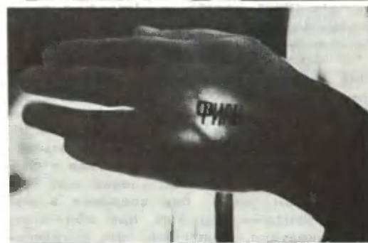
Интроскопия руки при нажатии ею на плексигласовый цилиндр-световод. Хорошо видны вены и надпись, сделанная шариковой ручкой на тыльной стороне ладони. Экспозиция 30 с в луче лазера мощностью 15 мВт.
