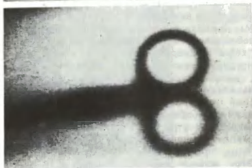
Интроскопия слоя поролонa толщиной 21 мм с ножницами внутри. Вверху — без сжатия, внизу — при сжатии до толщины 7 мм. Экспозиция в свете лампы накаливания мощностью 60 вт — 1/30 с.
