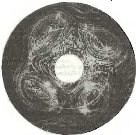
Цепочка циклонов, генерируемая при скачкообразном профиле предельно сближенных зональных течений (направление течений циклоническое). Белая окружность — граница между течениями.
