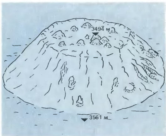
Внешний вид крупной потухшей гидротермальной постройки на полигоне ТАГ. Она имеет вид усеченного конуса с диаметром у основания около 200 м, высотой около 70 м. Постройка защищена от растворения в верхней части плитками и корками бернессита, в нижней — рыхлым нонтронитом.
