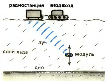
Схема эксперимента по «плавлению во льду» под действием мощных радиоволн.
