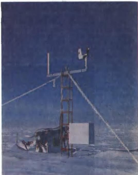
Автоматическая метеостанция в Центральной Антарктиде. Непрерывная регистрация метеорологических характеристик позволяет более точно интерпретировать данные ледяного керна.
