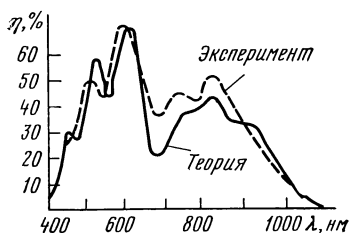
Рис. 3.1. Зависимость квантового выхода от длины волны для матрицы ФПЗС с оптимизированными толщинами слоев оксида и поликремния
