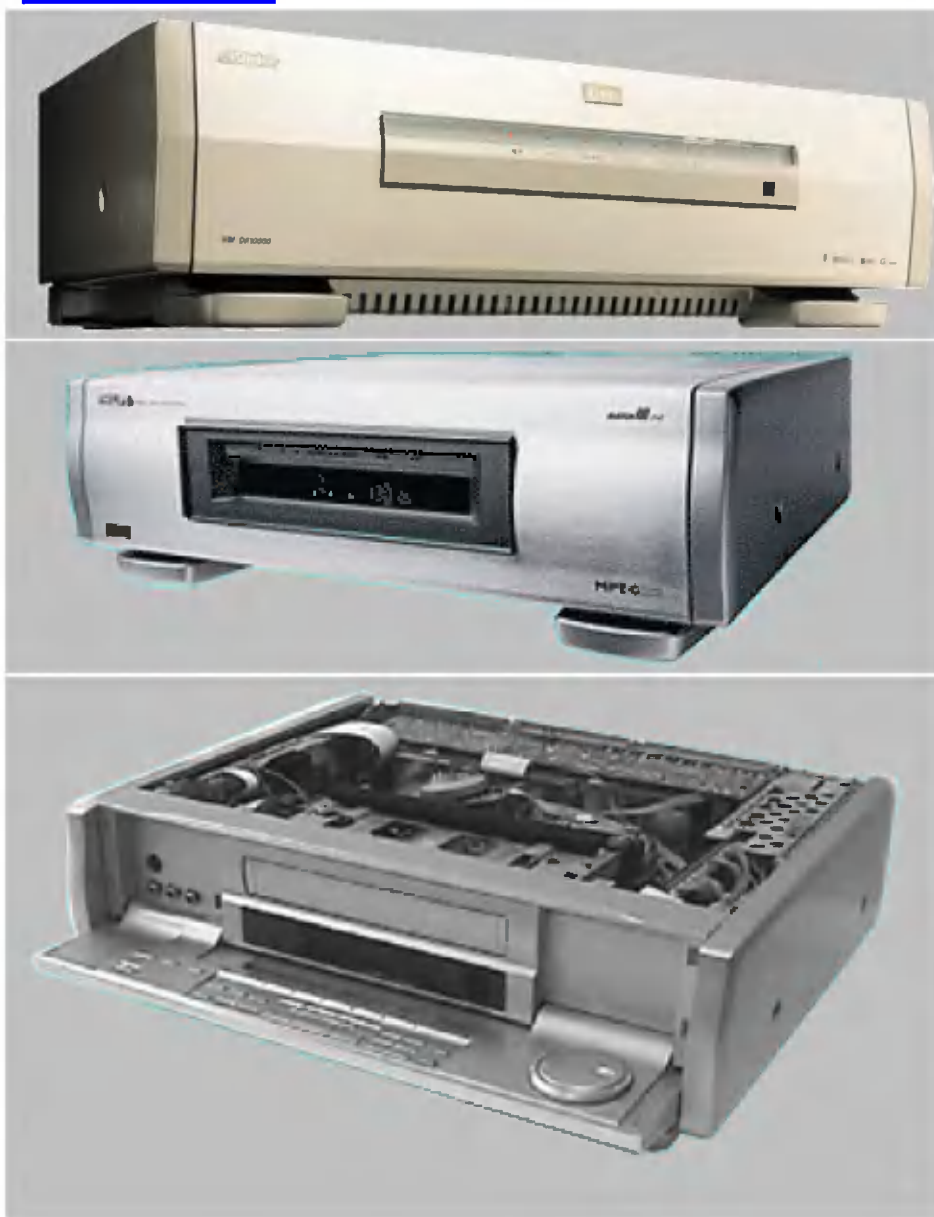
Видеомагнитофоны DVHS JVC HM-DR10000 (сверху) и Philips VR20D (снизу, в том числе с открытым корпусом и откинутой передней панелью)
