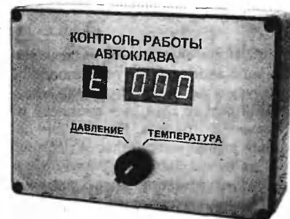
Рис. 6. Габариты и внешний вид универсального индикатора в сборе
