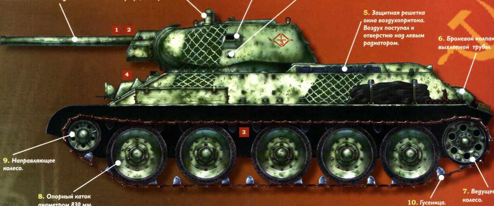
сварную броневую коробку с продолговатой закругленной носовой частью и кормой. Для увеличения снарядостойкости верхняя часть обоих бортов делалась наклонной.
