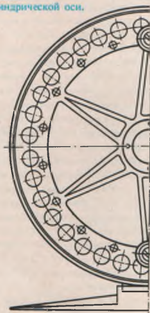
Рис. 2. Вариант катушки с барабаном на цилиндрической оси.
