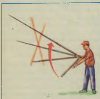
Рис. 3. Сборка удилица: 1 — правильная; 2 — неправильная (сборка взмахом ведет к заклиниванию колен).
