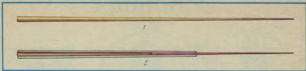
Рис. 2. Вершинка удилица: 1 — полая (пустотелая); 2 — составная.
