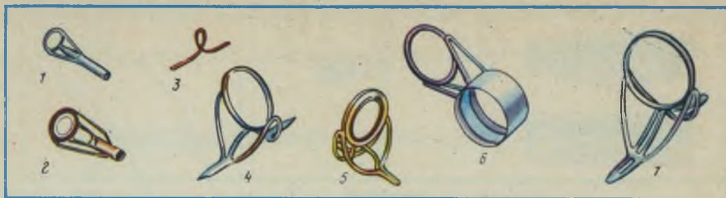
Рис. 11. Конструкции пропускных колец: 1 — «тюльпан» простой; 2 — «тюльпан» комбинированный; 3 — простейшее проволочное кольцо; 4 — проволочное кольцо на лапках; 5 — комбинированное кольцо на лапках; 6 — комбинированное кольцо на втулке; 7 — облегченное кольцо «Dynaflor».
