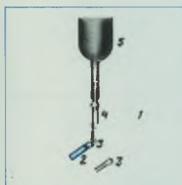
Рис. 15. Способ застопоривания скользящего поплавка: 1 — леска; 2 — отрезок радиоизоляции; 3 — проволочная петелька; 4 — застежка; 5 — поплавок.
