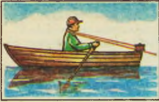
Рис. 3. Мотовильце укреплено в скобах на кормовой доске.
