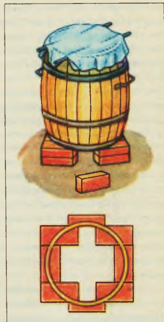
Рис. 1. Самоделная копильная печь из деревянной бочки: вверху — общий вид; внизу — горизонтальное сечение.
