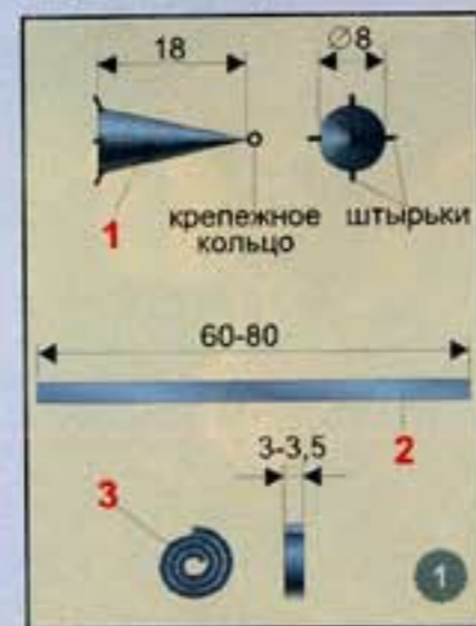
1. Грузило: 1 - основное грузило; 2 - свинцовая полоска; 3 - спиральная свинцовая шайба.
