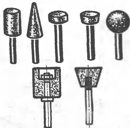
Рис. 2. Твердые абразивные головки и способы их посадки на оправку.
