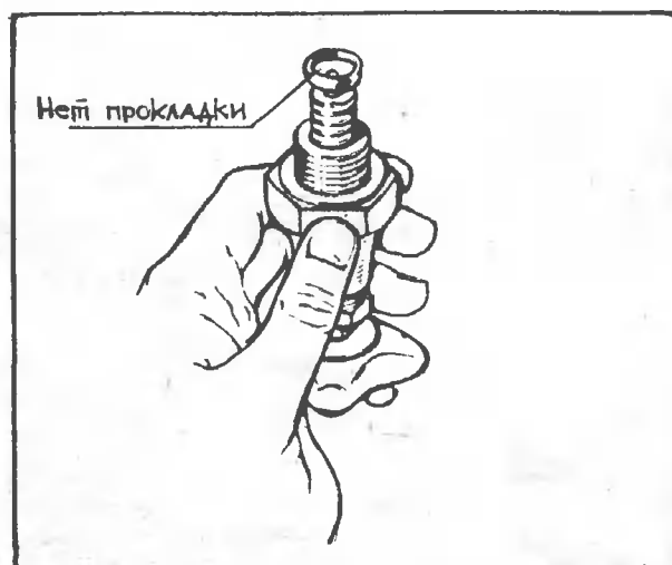
Рис. 4. Прокладка в клапане крана или смесителя отсутствует.
