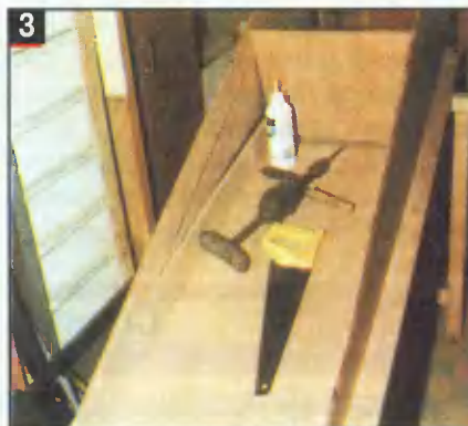
3 Шкаф-опору можно сделать из различного материала: фанеры, ДСП, столярных щитов, брусков и досок.
