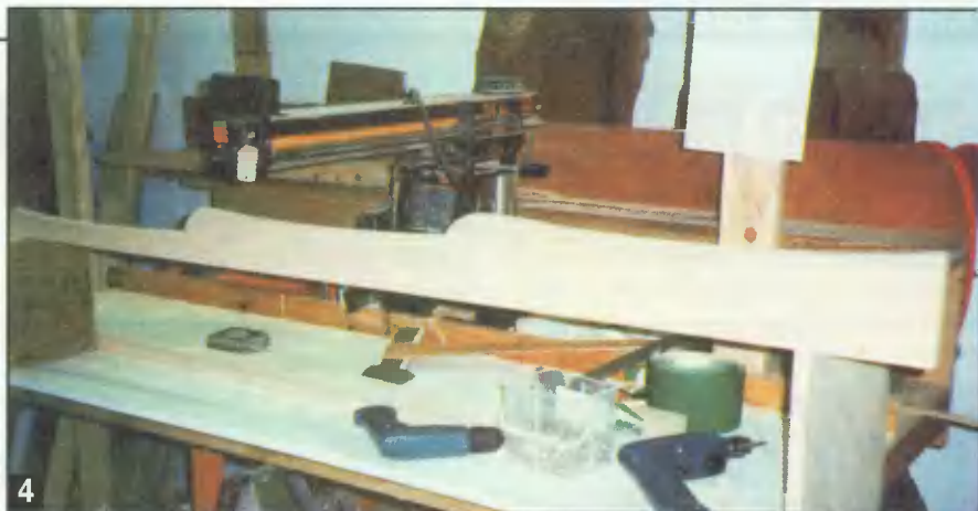
4 Сборку начинают на верстаке. Полку устанавливают в паз одной из боковых ножек. Другой конец этой ножки опирают на подставку.
