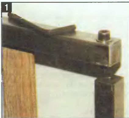
1 Направляющую раму можно сделать сборно-разборной, если собрать ее на винтах, используя вставки-бобышки с резьбовыми отверстиями.
