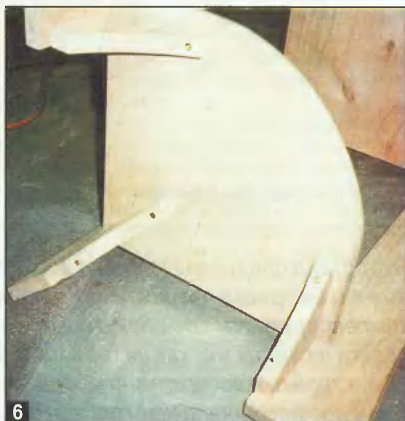
6 Укосины ножек крепят в последнюю очередь. Их делают из обрезков, оставшихся от выкройки полок.
