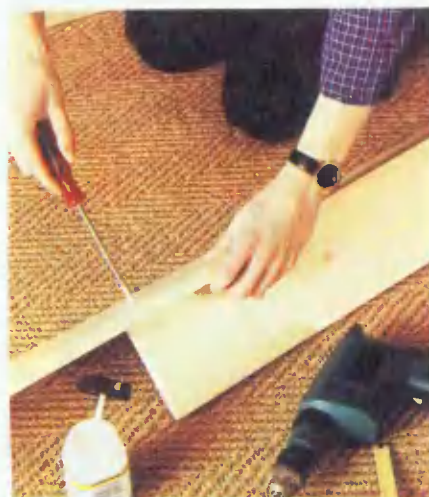
Из двух досок, собранных на клею и шурупах, можно получить угловой профиль.
