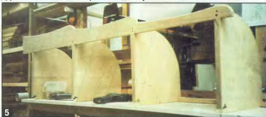
После установки на место первой ножки устанавливают и закрепляют вторую боковую ножку. Центральную ножку прикрепляют последней.
