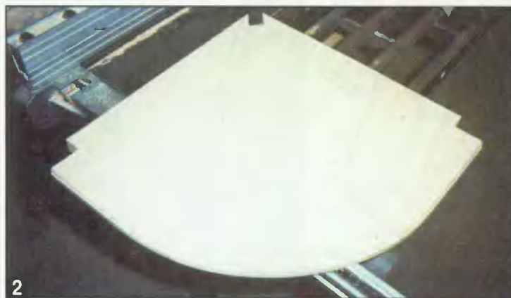
2 Полки выкроены в размер того места, где будет стоять этажерка. Пазы для ножек выпилены ножовкой.
