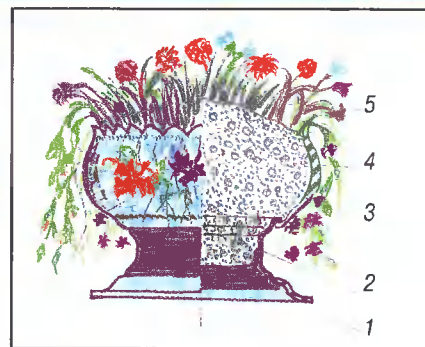
Цветочный вазон из автомобильного колеса: 1 — опоры вазона — отрезанная часть боковины шины; 2 — колесный диск; 3 — вывернутая наизнанку шина; 4 — грунт; 5 — цветочная рассада.
