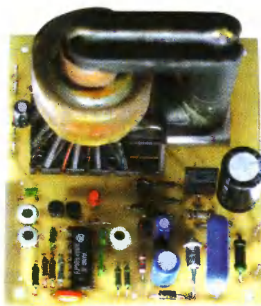
Рис. 3. Собранный преобразователь напряжения на базе трансформатора строчной развертки.
