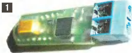
Рис. 1. Номинал емкости C3 определяет время плавного включения лампы, номинал сопротивления R1 – время гашения. Пользователь может самостоятельно подобрать эти номиналы. Подробнее об этом см. журнал «САМ» N12-2006 г.
