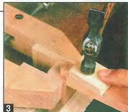
3 Подгонка «ласточкиного хвоста» верхней перемычки крышки стола. Зажим предотвратит ножку от раскалывания, если шип слишком большой. Соединение должно быть плотным, но не тугим.
