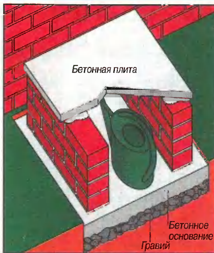
Рис. 4. Цоколь, возведенный из кирпича на отлитом из бетона основании. На стенке уложена бетонная плита под бочку.
