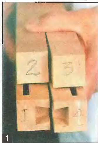
1 Разобраться с ножками легче, если их торцы пронумеровать по часовой стрелке. Это поможет избежать ошибок при разметке деталей.
