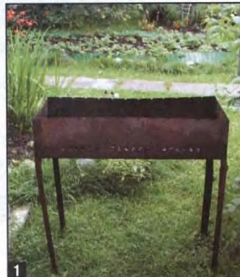
Серийный мангал после года эксплуатации.
