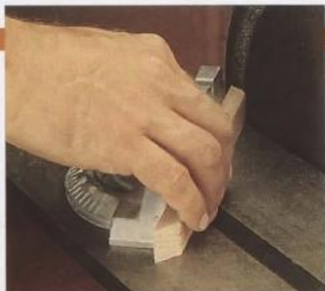
Вырезанные с небольшим припуском окантовывающие рейки точно подгоняют по длине на дисковом шлифовальном станке.
