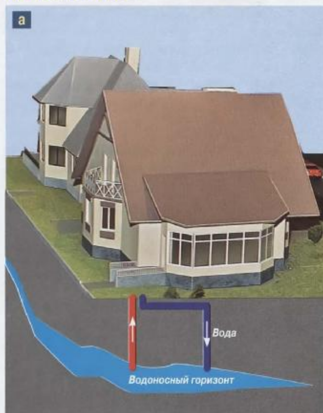
Рис. 2. Конструктивные разновидности контуров отбора земного тепла в системах тепловых насосов: а — с открытым циклом; б — с закрытым циклом (горизонтальный теплосъёмный коллектор); в — с закрытым циклом (вертикальный скваженный зонд).
