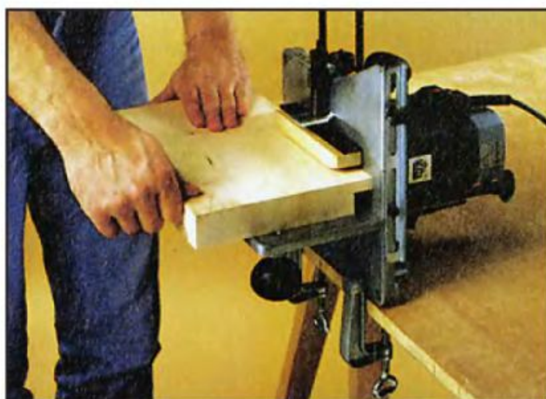
Простой универсальный столик позволяет установить фрезерную машинку в нужное положение и использовать её как настольный электроинструмент.
