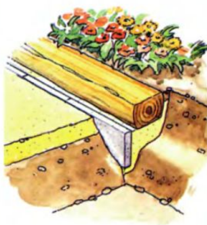
Двухкантный брус со стороны клумбы контактирует с землёй, а со стороны садовой дорожки его подпирают бордюрные камни.
