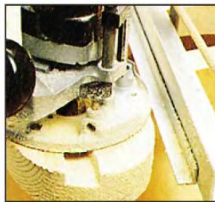
Алюминиевый профиль используется в качестве дополнительной направляющей при фрезеровании паза на пласте заготовки.
