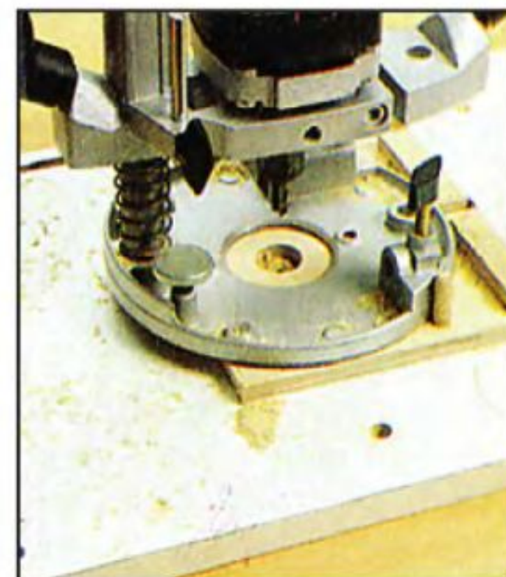
Используя самодельное приспособление, в деталях сверлят отверстия под шканты с помощью фрезерной машинки.
