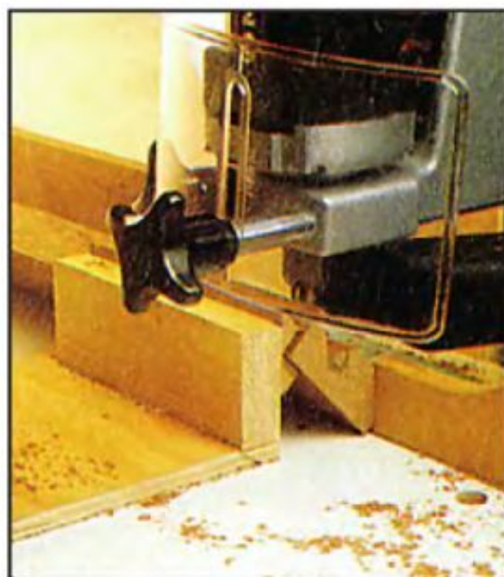
Простое приспособление позволяет обрабатывать наклонённую деталь. Для смазки деревянных направляющих годится воск от обычных свечей.
