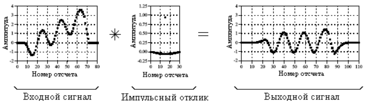
Рис.6.3 Примеры высокочастотной и низкочастотной фильтрации использующей свертку
