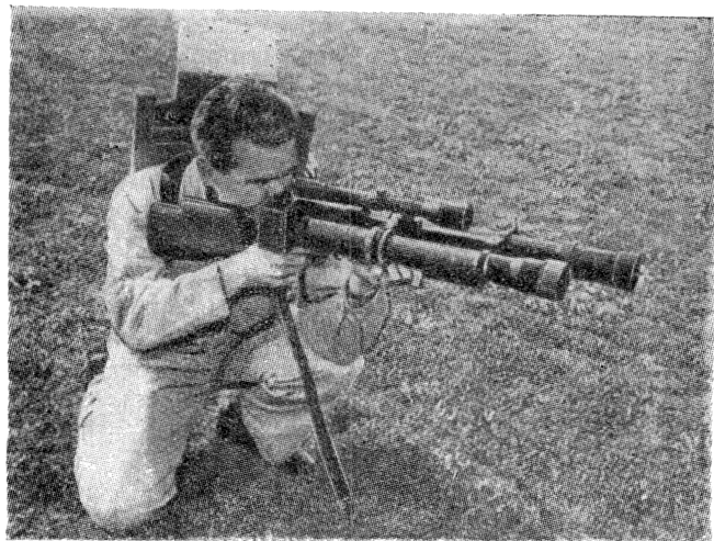
Фиг. 3. Лазерный дальномер «Колидар» Mk.2 фирмы Хьюз
